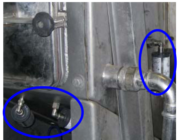
BESLUX LUBE dosificando grasa del tipo alimentario homologada por NSF en la categoría H-1.
