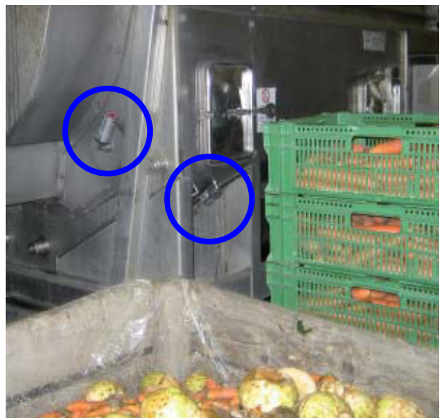
Dos BESLUX LUBE lubricando la instalación de lavado.
