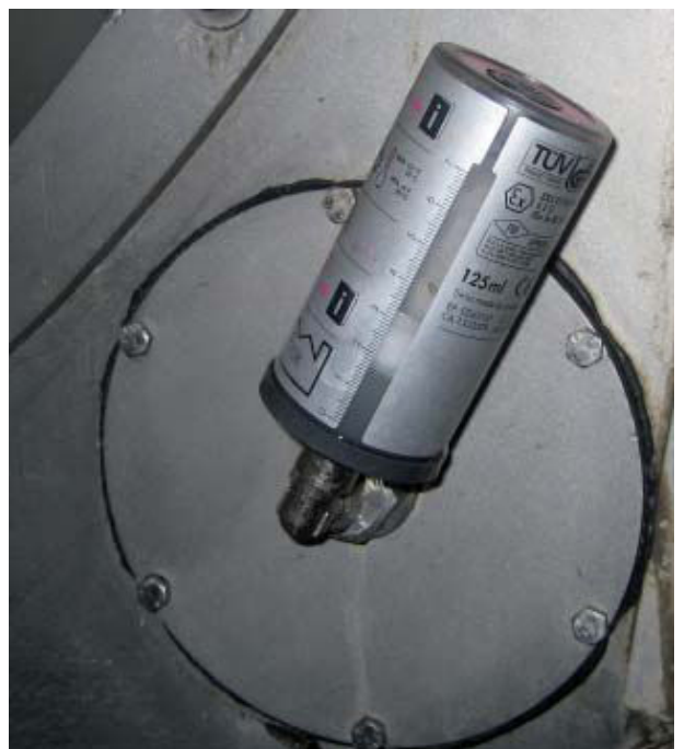
Un dispensador BESLUX LUBE de 125 ml en un rodamiento.
